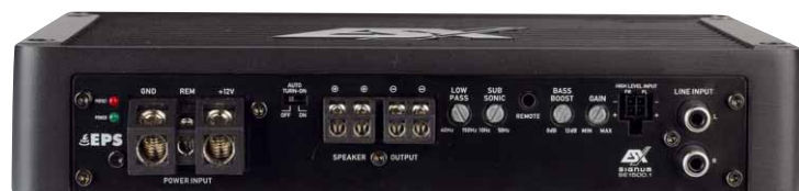
Links die 1500.1 mit kräftigen Terminals und doppelten Anschlüssen für dicke Drähte, rechts die 800.6 mit Molex Multipolsteckern für die 6 Eingänge und Ausgänge
