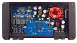
Arbeitsspannung zu kommen. Schließlich darf auch noch der mechanische Aufbau gelobt werden; hier lässt sich ESX nicht lumpen und spendiert überaus solide Aluminiumgehäuse mit reichlich Kühlkörper und stabile Terminals für die Kabel.
