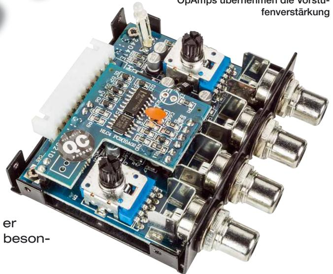
Ein High-Low-Adapter ist der Helfer in der Not. Bei Kontaktschwierigkeiten zwischen Werksradio und Endstufe hilft er genauso wie gegen lästige Störungen. Wir begutachteten ein besonders edles Modell.
